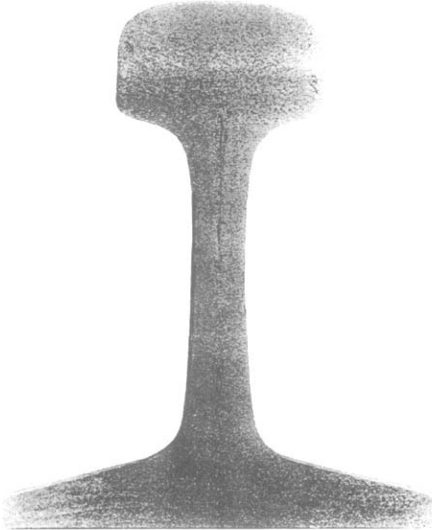
图 F.6 延长至轨头或轨底的轨腰中心条纹
